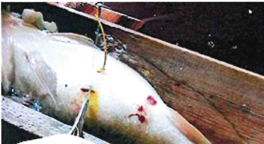
DST-mærke (data logger) er opereret ind i bughulen hvor plastiksnoeren kan ses på yderside.
