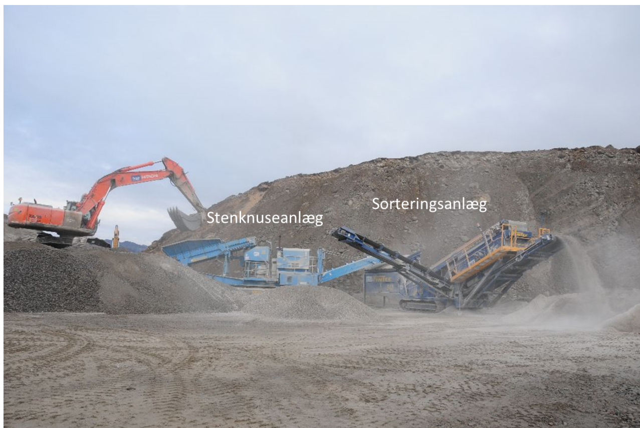
Figur 1 Stenknuse- og sorteringsanlæg anvendt ved etableringen af vandkraftværket ved Ilulissat.
