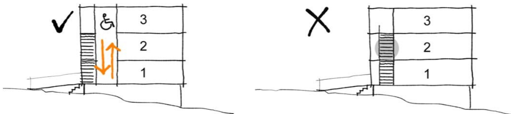
Figur 11: Ved adgangsetage plus to etager ovenpå kræves installation af elevator mindst af type 2 i størrelse efter DS/EN 81-70.
