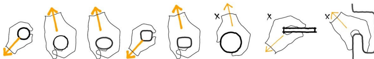
Figur 17: Hånden bør kunne lukke om profilet både nedefra og ovenfra, svarende til børns og voksnes højde, hvis det skal regnes for gribeegnet. Hvis hånden ikke kan nå rundt omkring profilet, kan der ikke overføres så mange kræfter.
