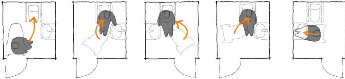
Figur 22: Vendearealet foran wc og håndvask anvendes både til manøvrering og til forflytning til wc. Pladsen på begge sider af wc'et kan også være nødvendig for en evt. hjælper. Foruden små manuelle kørestole anvender brugerne også store el-scootere og elkørestole. Behovet for hvor, stolene skal placeres, varierer stærkt efter personens funktionsnedsættelse og forflytningsmetode. Forflytning foregår oftest forfra i en vinkel til højre eller venstre. Nogle anvender kun håndvasken under toiletbesøget, fx til skift af kateter.
