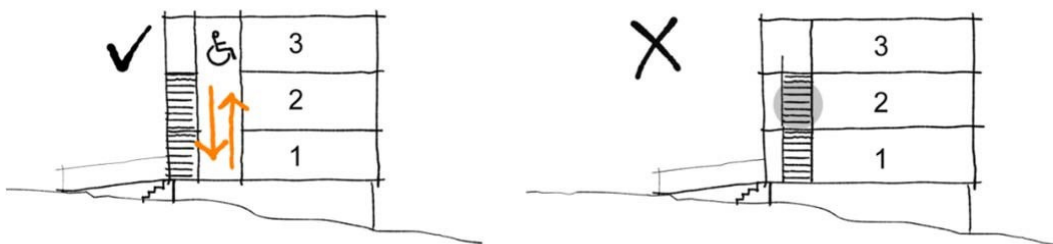
Figur 11: Ved adgangsetage plus to etager ovenpå kræves installation af elevator mindst af type 2 i størrelse efter DS/EN 81-70.
