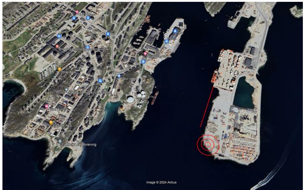
Figur 4-3 Ikummatissaasivik inissinneqarsinnaavoq kilisaatinut umiarsualiviliassap kujammut isuatungaani. Nigalik ilorleq tassa ikummatissaasivik (tanki). Nigalik ilorliup silataaniittoq tassa qarmaq betoniusoq, uuliakoortoqassangaluarpat illersuutaasussa. Nigalik avalleq killeqarfiuvoq navianartumut ataqineqartussa. Takuuk oqaasertalerna.
