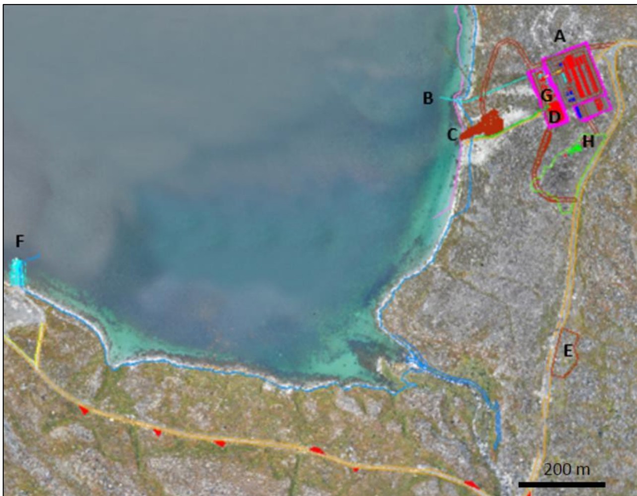
Takussutissiaq 5: Najugaqarfimmi atortulersuutit sumiiffii aaqissorerilu (A: Najugaqarfik: B: Kangerlummut maqitsiviit. C: Talittarfiit. D: Orsussaassivik. E: Misissuiffik / Sanaartorfik: F: Talittarfik: G: Innaallagissiorfik: H: Najugaqarfiup mittarfia)
