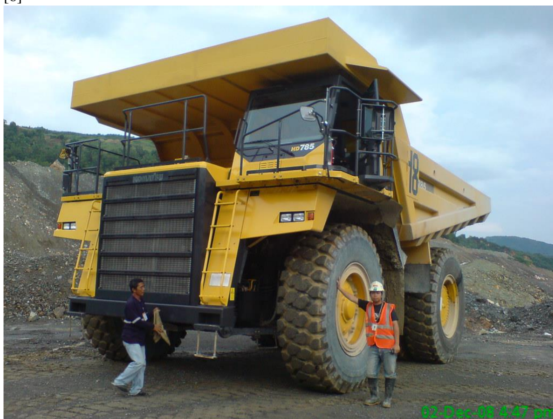
Komatsu 785, Kæmpe lastbil 72 tons. Kan laste 92 tons. [6]
