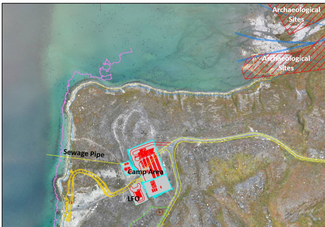
Figur 10: Potentielle udledningssteder for spildevand fra lejren (Sewage Pipe = Spildevandsrør, Camp area = Lejr område)
