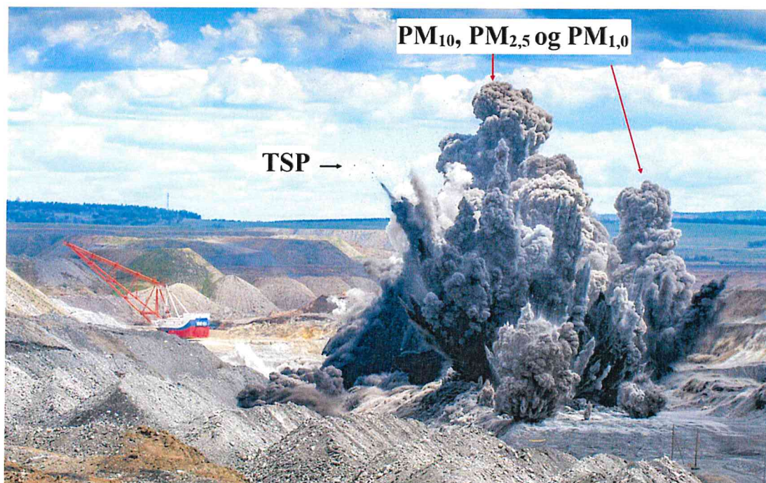
Billede 5. Sprængning på åben mine og spredning af støvpartikler.
