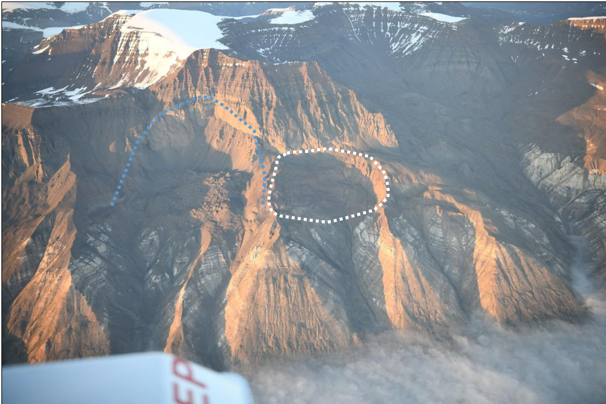
Figur 13: Skråfoto fra helikopter af Paatuut Øst. Det store volumen af løse sedimenter (markeret med hvidt stiplet omrids) ligger i 700–900 m højde umiddelbart øst for kildeområdet for Paatuut 2000 fjeldskredet (blåt stiplet omrids).
