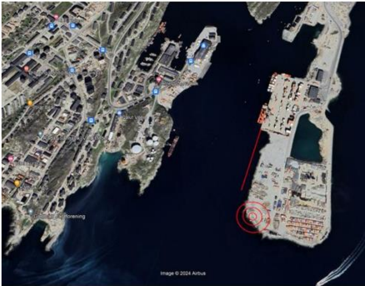
Figur 5: Placering for et muligt tankanlæg og nærmeste omgivelser i den sydlige ende af Trawlerterminalen. Den inderste ring viser selve tanken. Næste ring viser omfanget af den omkringliggende ringmur, der kan rumme evt. spild af olie. Yderste ring skitserer respektafstanden.
